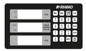
**CERO.** Muestra que no hay ningun peso detectado sobre la báscula de plataforma.
