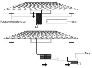
Finalmente coloque la tapa de la plataforma nuevamente en su lugar. Ya puede utilizar su plataforma y conectarla a un indicador electrónico.
